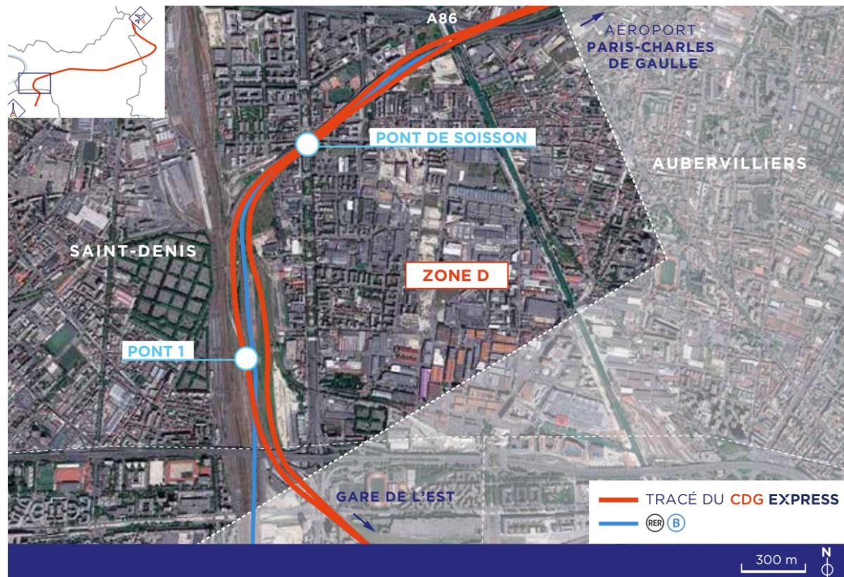
**Le raccordement des voies du CDG Express** depuis les ouvrages de la Porte de La Chapelle est fait par la réalisation d'un terrier passant sous les 2 voies existantes RA et VC pour l'une des voies du CDG Express et par
