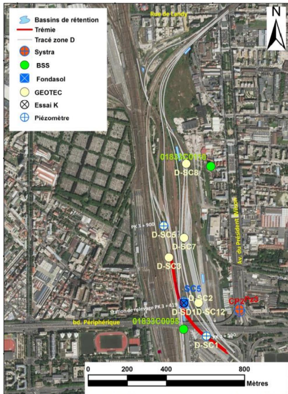
Figure 10 : Emplacement des sondages sur la zone D
